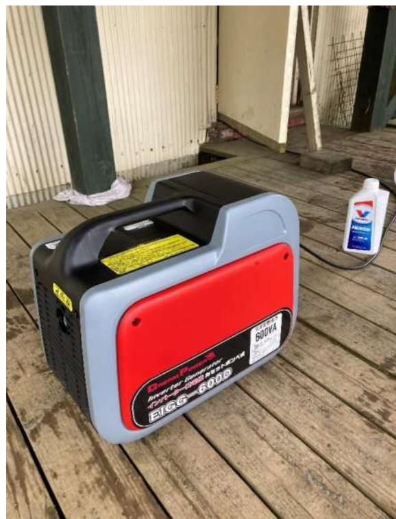
ガスボンベ式エンジン発電機
